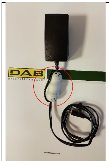
Image 11 - Position du Noyau de Ferrite
