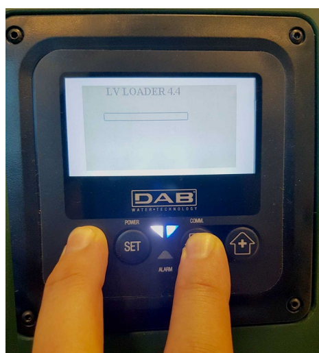
Image 9D - Accès au Chargeur pour la mise à jour de l'e.sybox mini3 Sw 1.X
