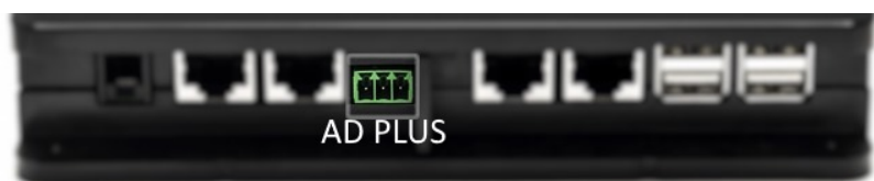
Рисунок 9А – Положение разъема в AD plus и в DConnect Box, пример подключения прямого кабеля can-bus к разъему DConnect Box для подсоединения AD plus
