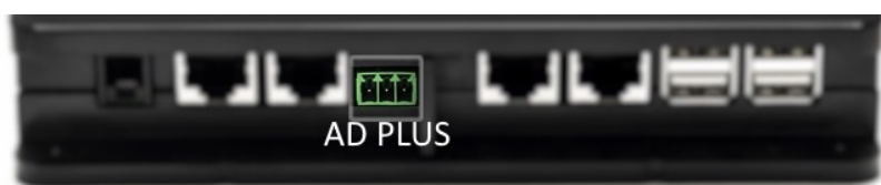
Obrázek 9A: Pozice konektoru v AD plus a DConnect Boxu, např. připojení CANBUS přímého kabelu, konektor s názvem DConnect Box pro připojení s AD plus
